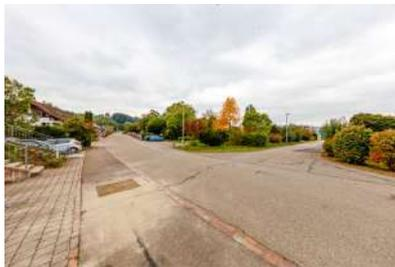
Die Obere Haldenstrasse ist mit der namenlosen Stichstrasse rechts an die Tuechstrasse angebunden. Die Einmündungen sind grosszügig gestaltet und führen zu hohen Fahr- und Abbiegegeschwindigkeiten.
