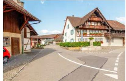
Blick in den von Süden nach Norden verlaufenden Teil bis zum Spar. Rechts das Restaurant zur alten Post mit durch eine Hecke an der Grundstücksgrenze abgeschirmter Aussenbestuhlung und Brunnen davor, beides gepflastert. Das nur 1.5 m breite nördliche Trottoir der Andelfingerstrasse ist unterbrochen. Nach der Ausrundung mit 8 m Radius ist die Strasse 6 m breit.
