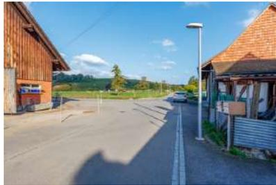
Die Einmündung der Botzengasse mit 10-Meter-Radius in die Worbigstrasse ist das Ende der Hauptschulwegs. Der Querschnitt verengt sich auf 4.2 m. Der Strassenkörper bildet den Abschluss der Bauzone.
