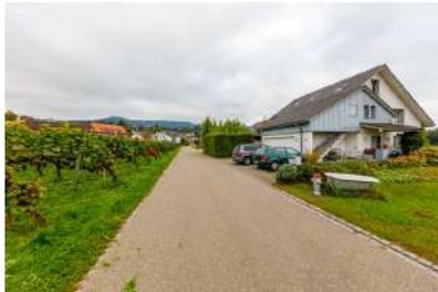
Die geradlinige Strassenführung mit einseitiger Bebauung inklusive zweier Baulücken verleitet zu hohen Fahrgeschwindigkeiten.
