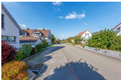
Die knapp 60 m lange und durchgehend rund 5 m breite Mühlebergstrasse von der Einmündung in die Rebenstrasse. Die Strasse verfügt als einzige in den Quartieren Amenloch / Oberdorf über ein 2 m breites Trottoir mit überfahrbarem Rand als doppelte Bundsteinreihe. Ausserhalb des Trottoirs befinden sich mehrere Längsparkfelder.
