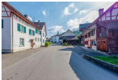
Blick nach Süden in Richtung Andelfingerstrasse. Die Strasse wird ab hier 6.3 m breit und ist sehr linear und kann so zu hohen Geschwindigkeiten verleiten. Fussverkehrsinfrastruktur fehlt und Einfriedungen zwingen Zufussgehende auf die Fahrbahn.
